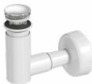
Syfon umywalkowy, czyszczony z góry, do umywalek bez przelewu, odpływ 32/40 mm, mosiężny, chrom
