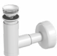
Syfon umywalkowy, czyszczony z góry, gardziel mosiężna, do umywalk z przelewem, odpływ 32/40 mm, korek click-clack, mosiężny, chrom
