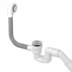
Syfon wannowy z przelewem, czyszczony od góry, korek click-clack ze stali nierdzewnej o średnicy 70mm, rura odpływowa 40/50mm
